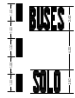
DETALLE DE MARCACION / Esc. 1:50
