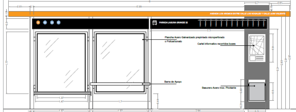
ELEVACION FRONTAL, PROPUESTA 1 ALTA CAPACIDAD, ESCALA 1:25
