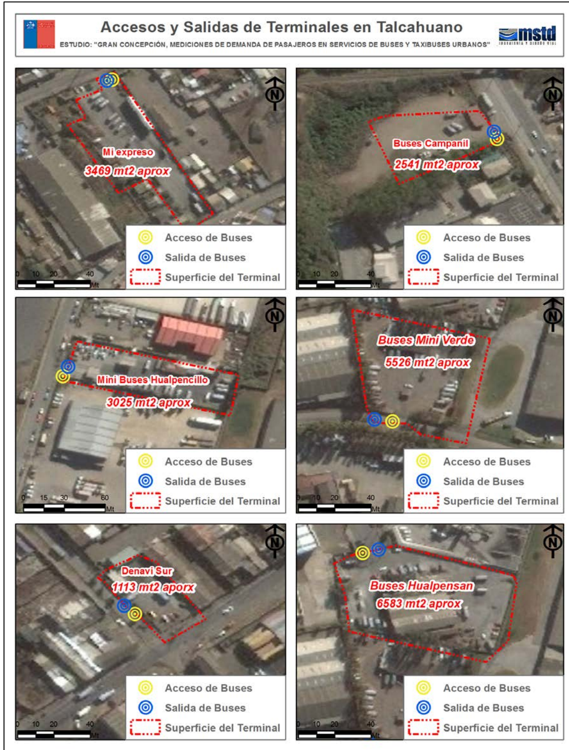
Figura N° 30: Puntos de acceso y salida de buses de terminales en la comuna de Talcahuano
