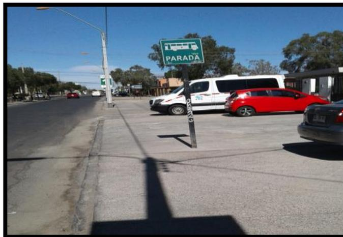
Se **propone** cambiar el emplazamiento de esta señal de Parada debido a que se encuentra ubicada en una entrada y salida de vehículos; se recomienda instalar a unos 25 metros al este de su ubicación actual.
