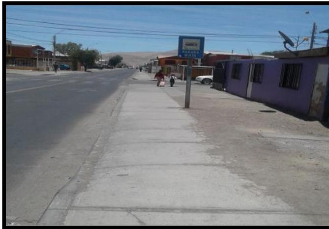
**Se propone** cambiar el emplazamiento de esta señal de Parada debido a que se encuentra ubicada en una entrada y salida de vehículos; se recomienda instalar a unos 18 metros al Oeste de su ubicación actual.
