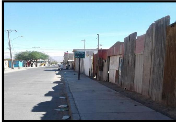
Se **propone** cambiar el emplazamiento de esta señal de Parada debido a que se encuentra ubicada en una entrada y salida de vehículos; se recomienda instalar a unos 22 metros al sur de su ubicación actual.
