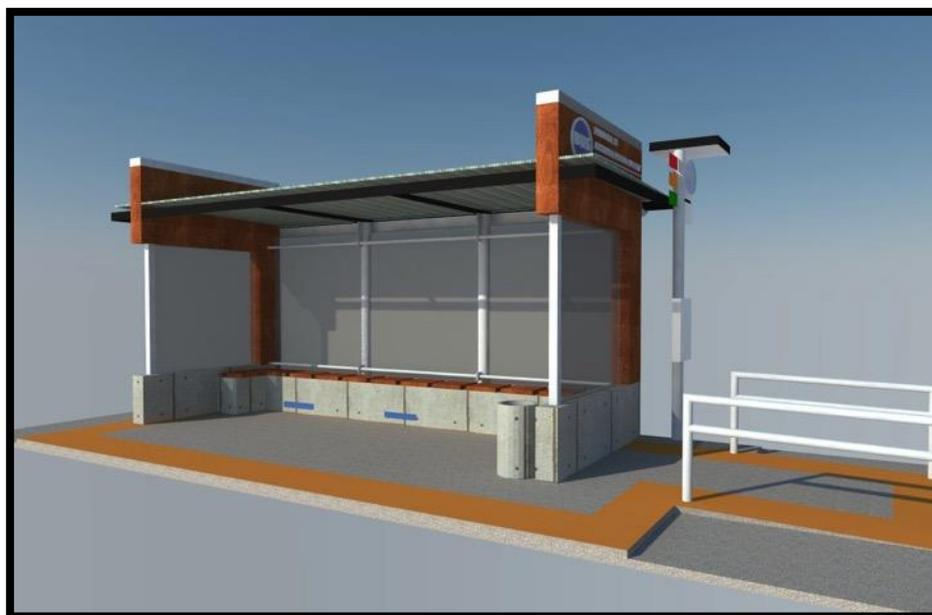
Fuente: Elaboración Propia: Selección de paradero con paneles acrílicos en sustitución de vidrio templado y contraste entre madera y hormigón.
