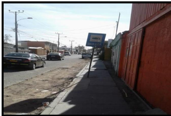
**Se propone** cambiar el emplazamiento de esta señal de Parada debido a que se encuentra ubicada en una entrada y salida de vehículos; se recomienda instalar a unos 10 metros al Este de su ubicación actual.
