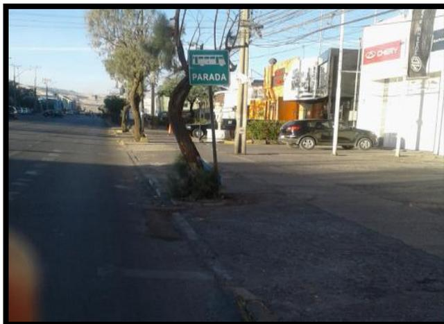
**Se propone** cambiar el emplazamiento de esta señal de Parada debido a que se encuentra ubicada en una entrada y salida de vehículos; se recomienda instalar a 90 metros al Norte de su ubicación actual.
