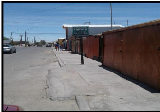
**Se propone** cambiar el emplazamiento de esta señal de Parada debido a que se encuentra ubicada en una entrada y salida de vehículos; se recomienda instalar a unos 50 metros al Oeste de su ubicación actual.
