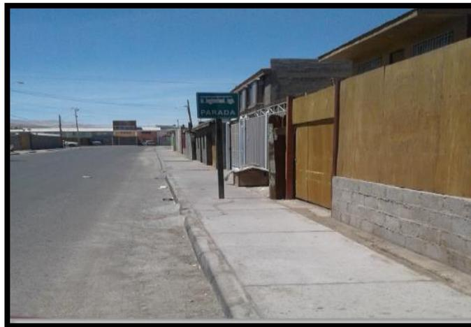
**Se propone** cambiar el emplazamiento de esta señal de Parada debido a que se encuentra ubicada en una entrada y salida de vehículos; se recomienda instalar a unos 35 metros al Norte de su ubicación actual.
