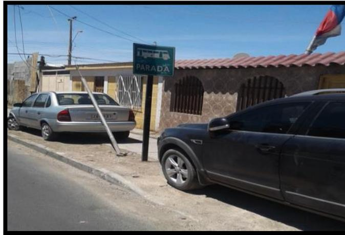
**Se propone** cambiar el emplazamiento de estaseñal de Parada debido a que se encuentra ubicada en una entrada y salida de vehículos; se recomienda instalar a unos 13 metros al Sur de su ubicación actual.
